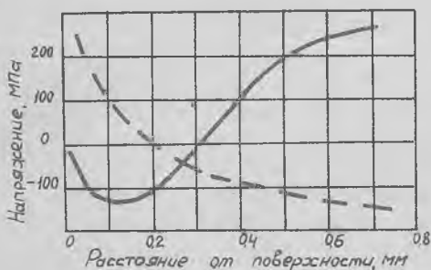
Р и с. 5. Эпюры тангенциальных остаточных напряжений
