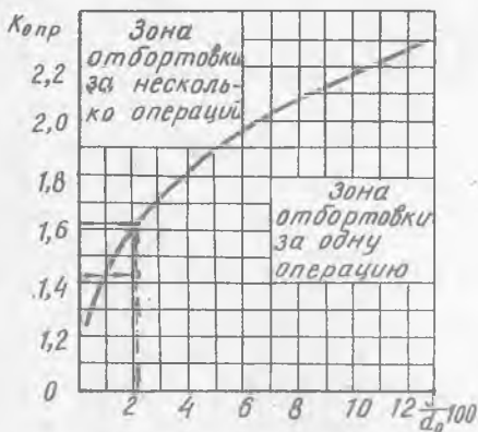
Р и с. 5. Зависимость предельного коэффициента отбортовки отверстия от относительной толщины материала K_{опр} = f(s/d_0 100) для материалов Д6АМ и АМг6М
