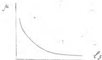
Рис. 9. График зависимости магнитной проницаемости материала от изменения немагнитного зазора
