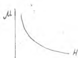
Рис. 11. График зависимости магнитной проницаемости от напряженности подмагничивающего поля
