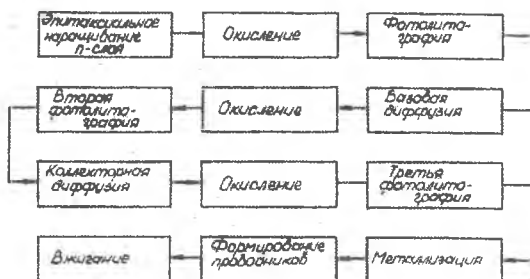
Рисунок 2. Схема технологического процесса изготовления И 2 Л – структуры
