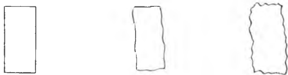
Рис. 3. Дефекты при изготовлении элементов методом трафаретной печати
