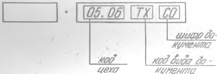
Р и с. 13. Пример кода спецификации к схеме расположения оборудования цеха изготовления мотогондол
