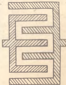
Рис.2.7.Конструкции тонкопленочных конденсаторов: а-однослойный ТПК;б-ТПК малой емкости;в-двухсторонняя конструкция ТПК;г-многослойный ТПК;д-гребенчатый ТПК
