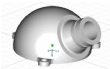
Рис. 2.28 Результат скругления ребра.
