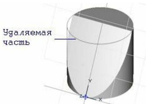
Рис. 1.18 Схема триммирования рабочей плоскостью
