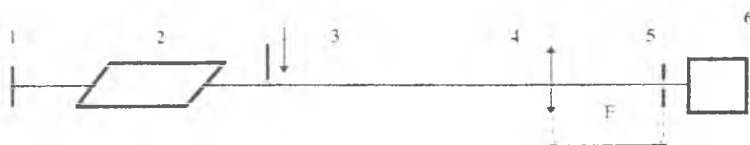
Рис. 2.7. Схема для определения ширины углового спектра одно- и двухпроходного СЛ и обычного лазеров при различных накачках: 1 - зеркало с R=100\% ; 2 - активная среда СЛ лазера; 3 - полупрозрачное зеркало; 4 - длиннофокусная линза; 5 - щель; 6 - фотоприемник.
