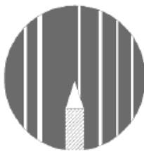
Рис.5.5. Вид поля зрения окуляра с набором спектральных линий и иглой-указателем
