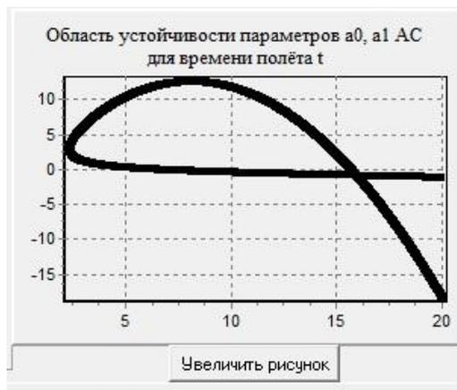
Рисунок 2.3 – Графическое отображение области устойчивости в плоскости параметров АС
