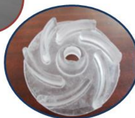
Рисунок 10 – Изготовление деталей из пластика по технологии литья в силиконовые формы
