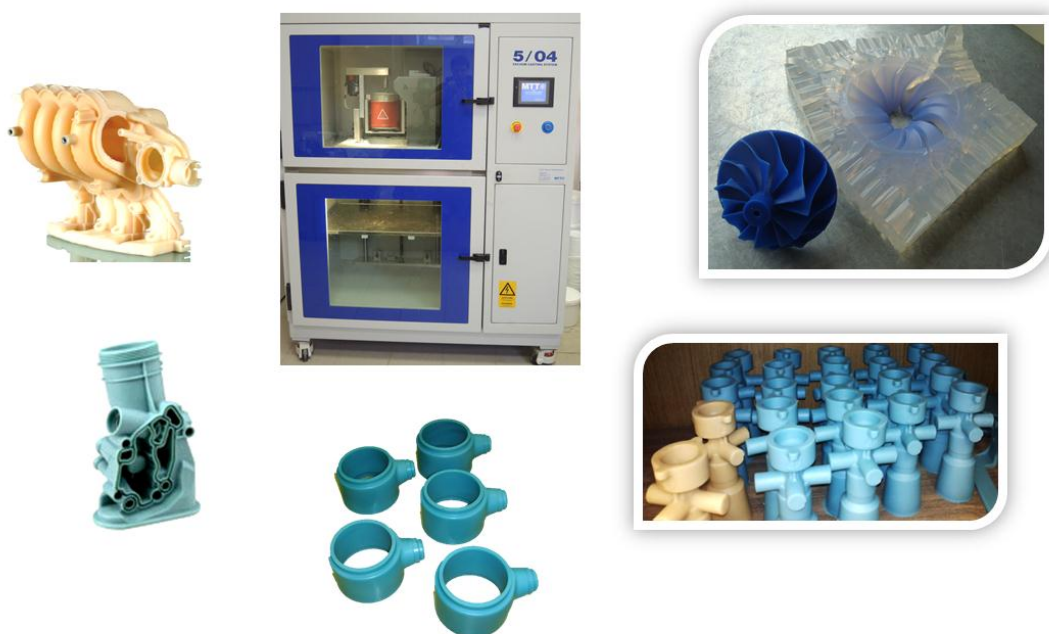
Рисунок 8 – Примеры изготовления деталей с помощью установки МТТ С5/04
