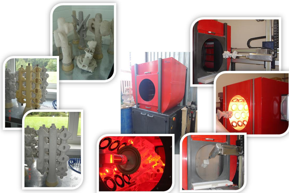
Рисунок 11 - Изготовление керамических форм
