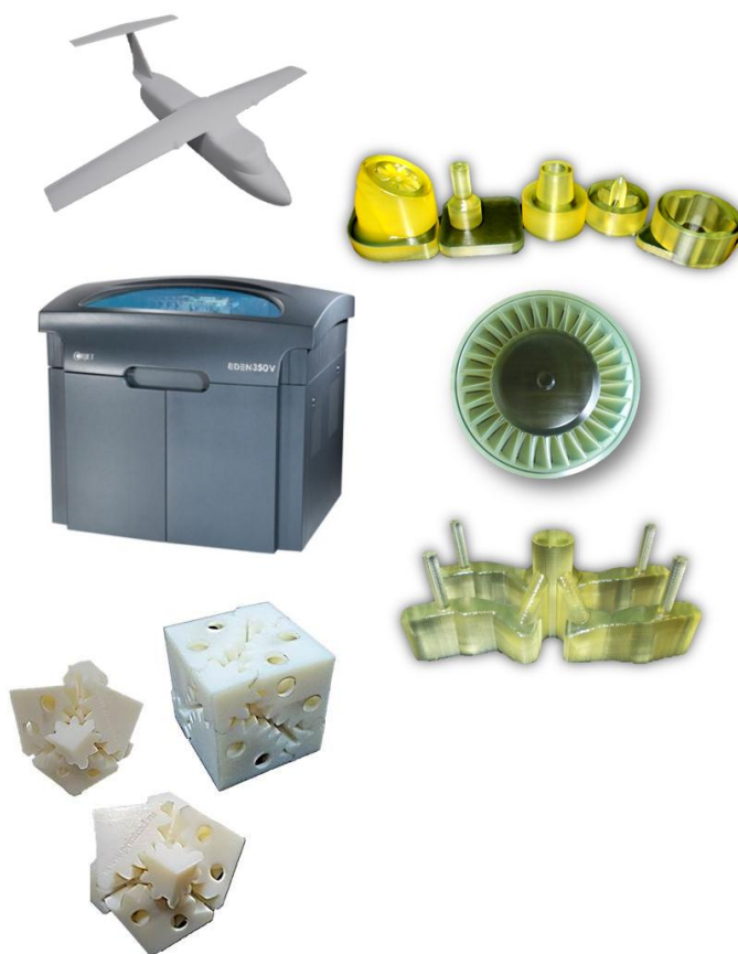
Рисунок 8 – Примеры изготовления деталей на 3D-принтере
