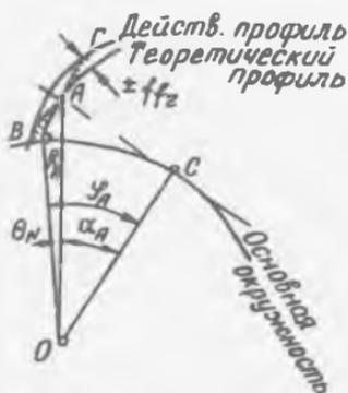
Р и с. 17. Схема построения действительного профиля зуба
