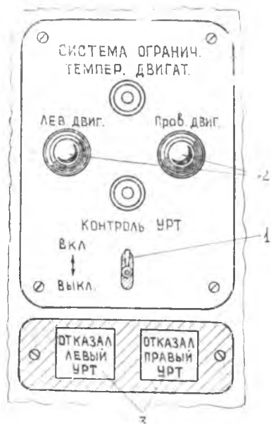
Рис. 6. Щиток управления УРТ-27: 1—выключатель; 2—сигнальные лампы левого и правого двигателя; 3—табло отказа УРТ
