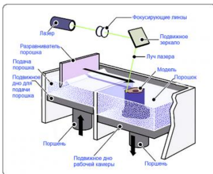
Рисунок 2 – Установка селективного лазерного спекания (SLS).
