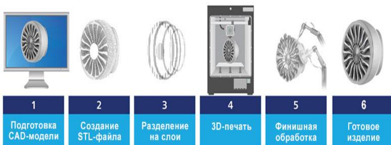
Рисунок 1 – Схема последовательности 3D-печать
