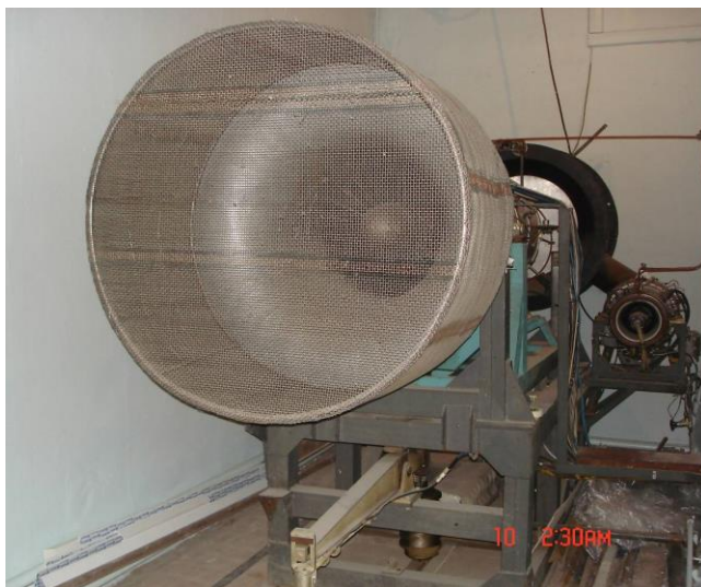
Рисунок 1.3 – Расположение ТРДД АИ-25 и ВГТД АИ-9 в боксе стенда
