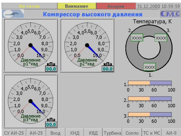
Рисунок 4.3 – Демонстрационная панель для регистрации параметров компрессора ВД
