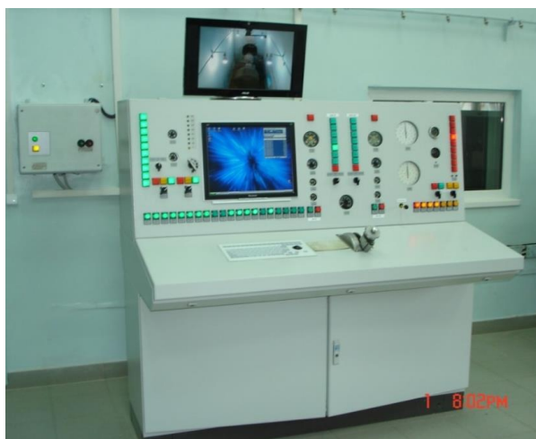
Рисунок 1.2 – Пульт управления учебно-экспериментального стенда для испытаний ТРДД АИ-25
