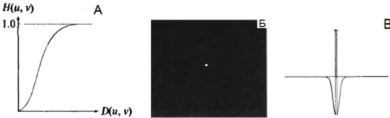
Рис. 10. А – радиальный профиль передаточной функции высокочастотного гауссова фильтра, Б – функция высокочастотного гауссова фильтра в пространственной области, В – профиль яркости пространственной функции фильтра
