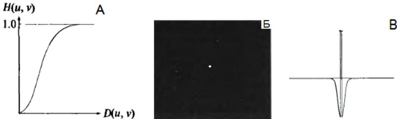
Рисунок 10 – А – радиальный профиль передаточной функции высокочастотного гауссова фильтра, Б – функция высокочастотного гауссова фильтра Баттерворта в пространственной области, В – профиль яркости пространственной функции фильтра
