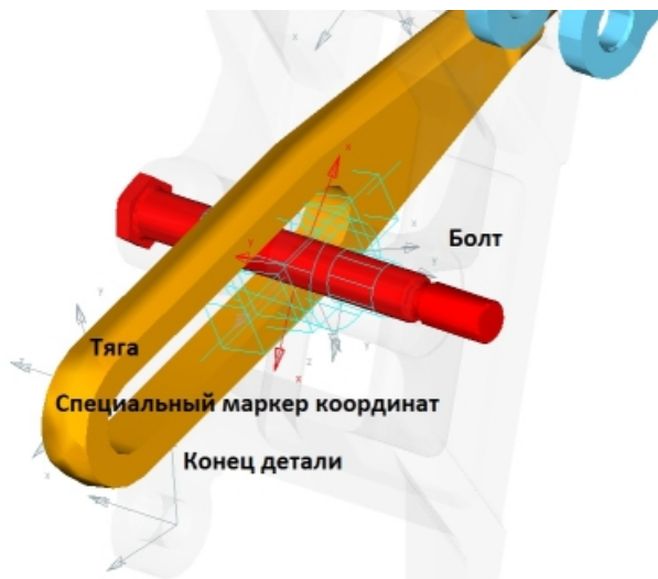
Рис. 14. Изменение расстояния между осью и концом тяги
