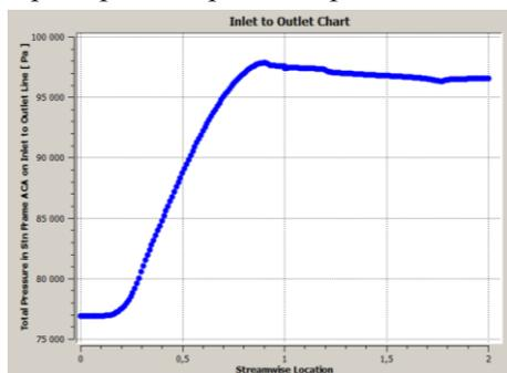
**Рис. 2.59 – График изменения среднего полного давления  $p^*$  по длине проточной части**
