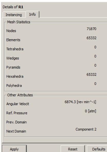
Рис. 2.66. Отображение информации о сетке на вкладке *Info*
