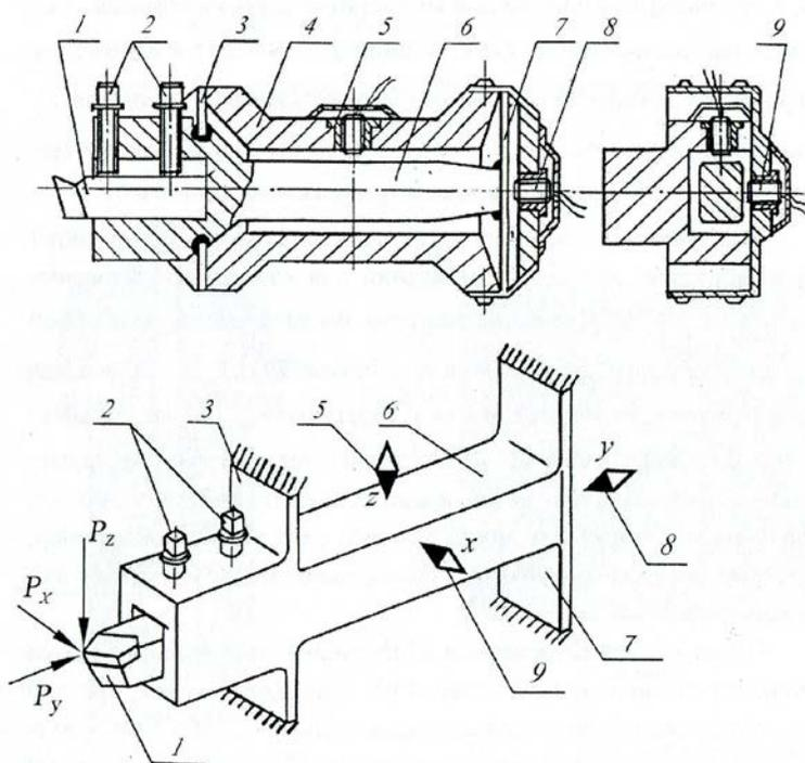
Рис. 2. Схема механической части динамометра
