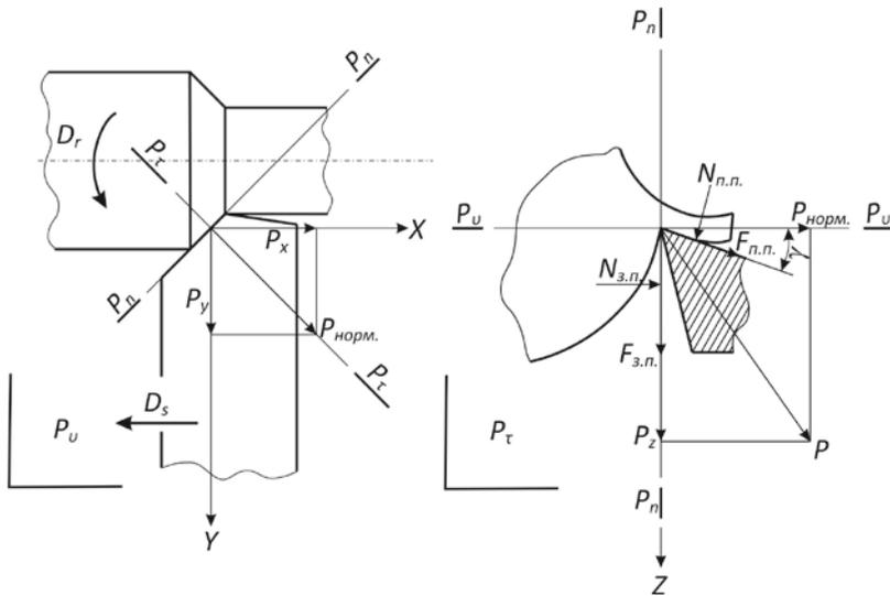
Рис. 1. Схема сил при точении проходным резцом
