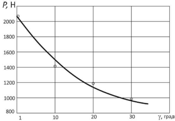
Рис. 7. Зависимость силы  $P_z$  от величины переднего угла
