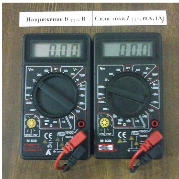
Рис. 80 – Положение переключателей для замера вольтамперной характеристики ТЭГ
