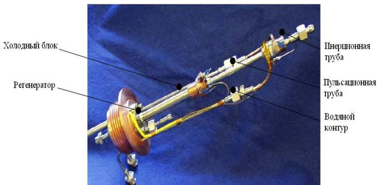
Рис.6. Опытная модель пульсационного охладителя линейной конструкции
