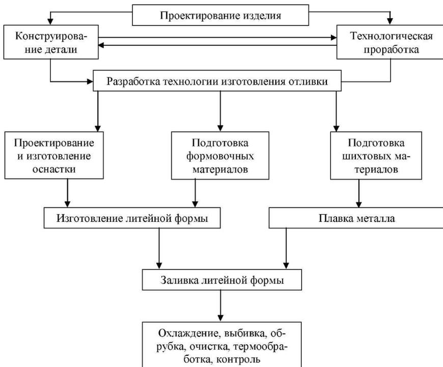
Рисунок 1 – Схема технологического процесса изготовления отливки.
