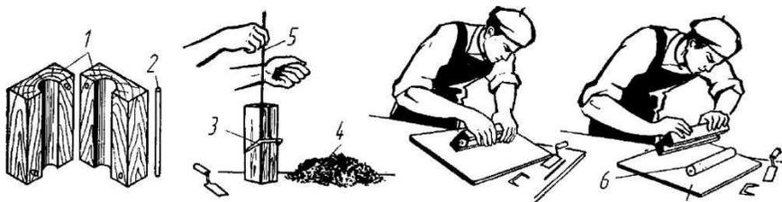
Рисунок 11 – Изготовление цилиндрического стержня по разъемному ящику:
