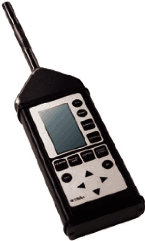
Рисунок 2.2– Внешний вид шумомера
