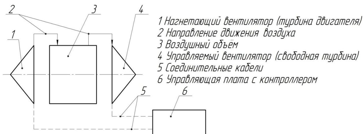
Рисунок 2 – Схема лабораторной установки
