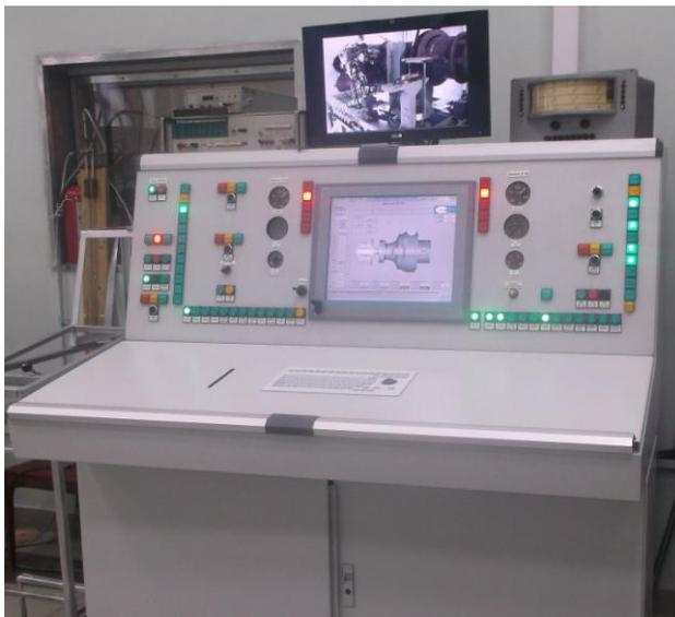
Рисунок 7 – Пульт управления стендом для испытаний ТВД ДГ-4М
