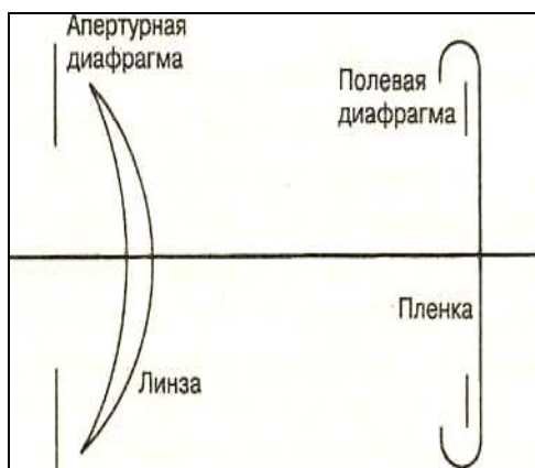
Рис.2.1 Оптическая схема фотоаппарата
