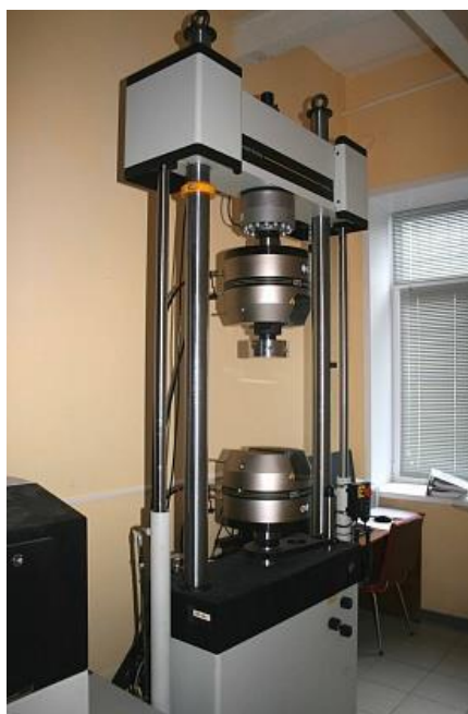
Рисунок 8 - Напольная система для проведения усталостных испытаний модели INSTRON 8802
