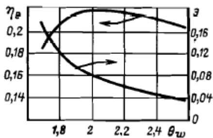
Рисунок 3.24 – Эффективность термомеханической машины при работе на азоне
