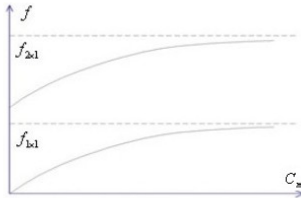
Рис. 14.7. Влияние податливости консольного закрепления на собственные частоты колебаний лопатки
