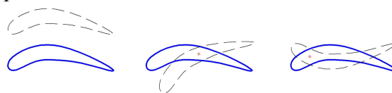
Рис. 14.11. Изгибные, крутильные и оболочечные колебания
