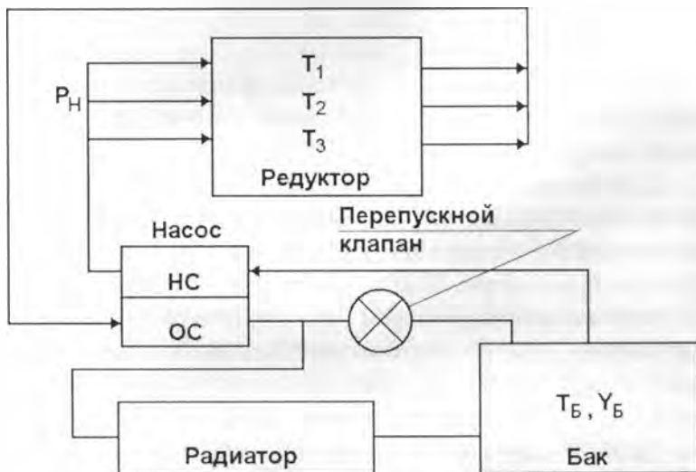
Рис. 3.2. Схема системы смазки редуктора
