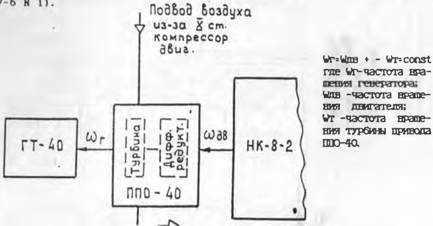
Рис. 6 Структурная схема поддержания частоты вращения генератора ГТ-40 пневмомеханическим приводом ППО-40
