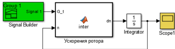
Рисунок 6 – Нелинейная модель двигателя в MatLab/Simulink
