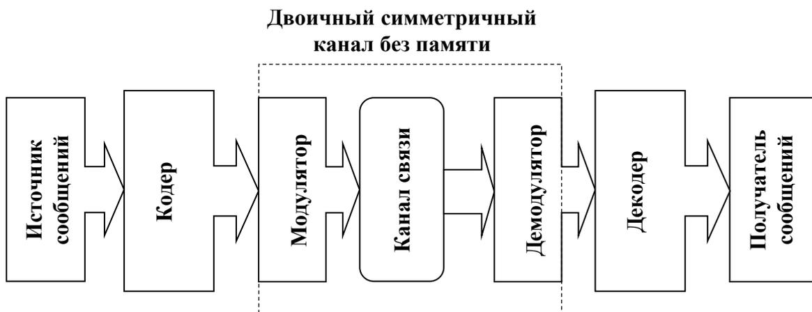
**Рисунок 18.1. Система связи с каналом передачи символов**
