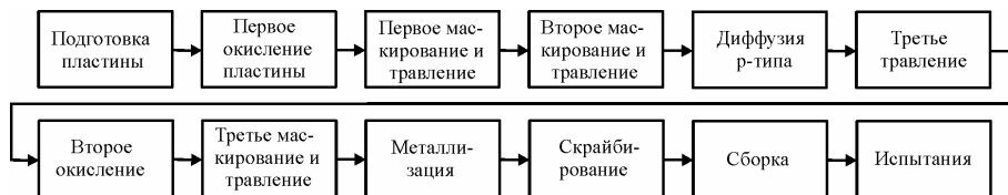
Рис. 2 – Схема технологического процесса получения униполярной микросхемы
