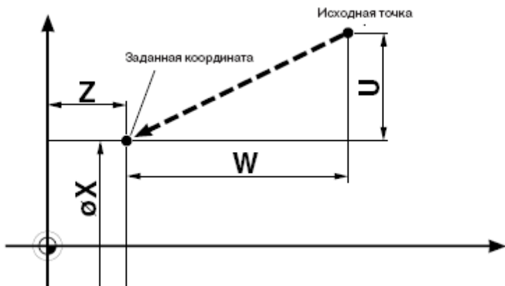
Рис. 3. Траектория движения конца резца в случае G0-оператора
