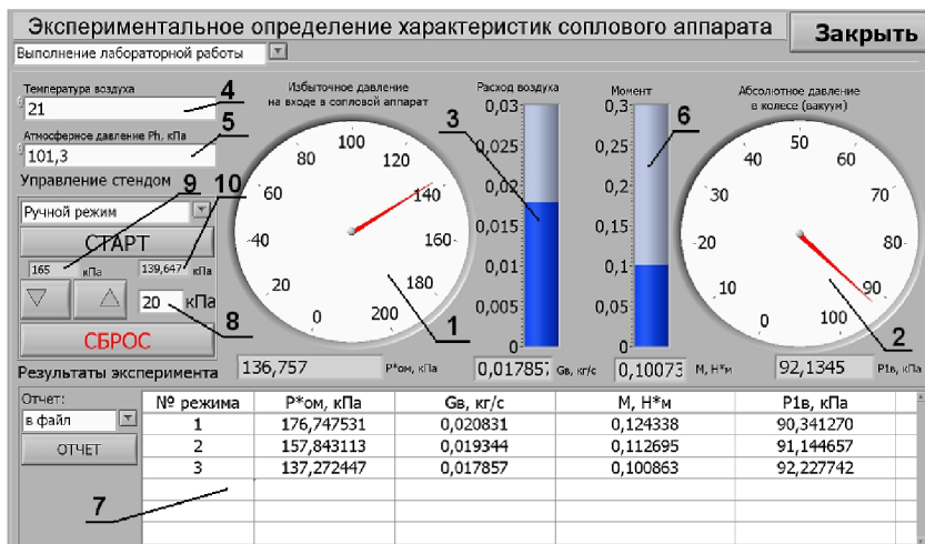
Рис.2.4. Внешний вид окна программы управления стендом и отображения результатов
