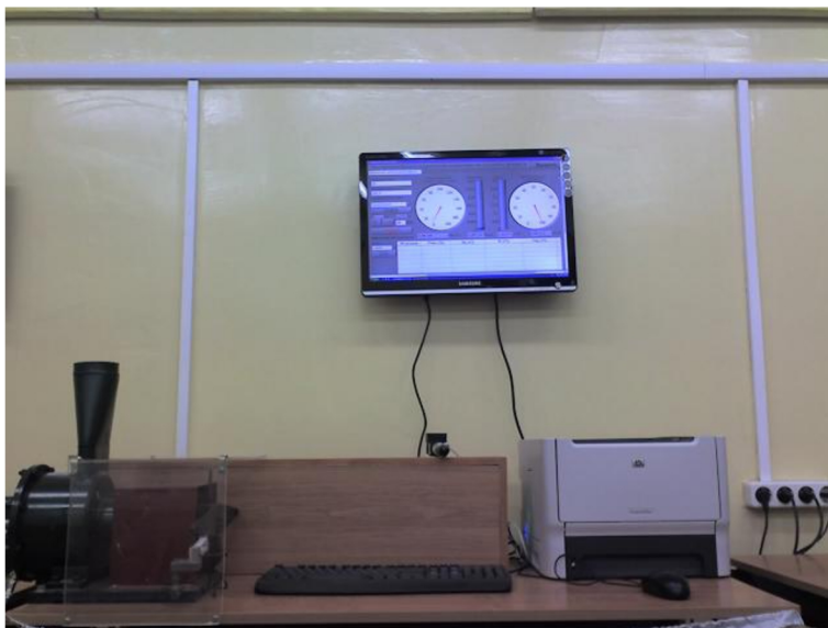
Рис. 2.2. Лабораторная установка для изучения рабочего процесса и снятия характеристик кольцевой центростремительной микротурбины
