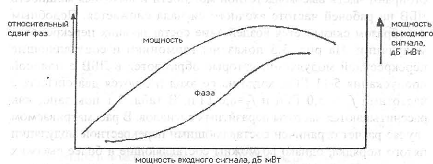
Рис. 3.2. Характеристика преобразования амплитудной модуляции в фазовую в ЛБВ
