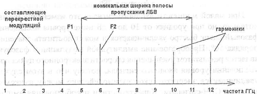
Рис. 3.3. Спектральные составляющие при перекрестной модуляции в ЛБВ
