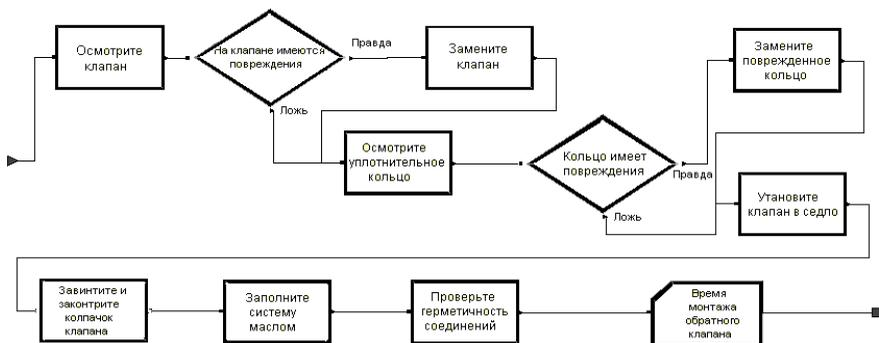
Рис. 1.10. Имитационная модель процесса технического обслуживания обратного клапана маслонасоса
