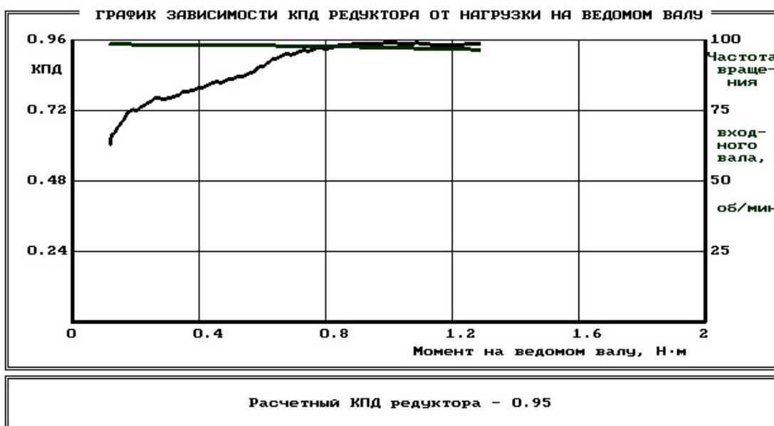
Рис. 58. График зависимости к.п.д. редуктора от нагрузки на ведомом валу (обработанный)
