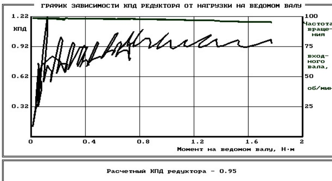
Рис. 57. График зависимости к.п.д. редуктора от нагрузки на ведомом валу (исходный)
