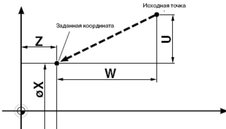
Рис. 3. Траектория движения конца резца в случае G0-оператора
