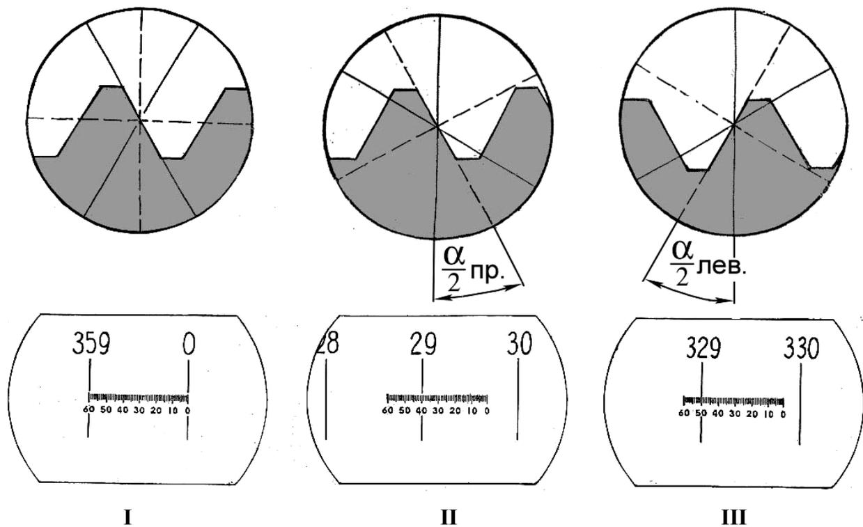
Рис.18. Схема измерения половины угла профиля резьбы.
