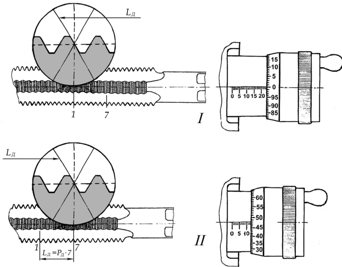
Рис.16. Схема измерения действительного значения длины участка резьбы для определения накопленной погрешности шага  $\Delta P$ .
