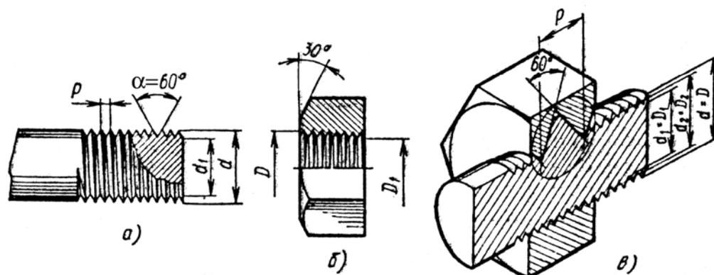
Рис.1. Наружная (а), внутренняя (б) резьбы, соединение болта с гайкой (в).
