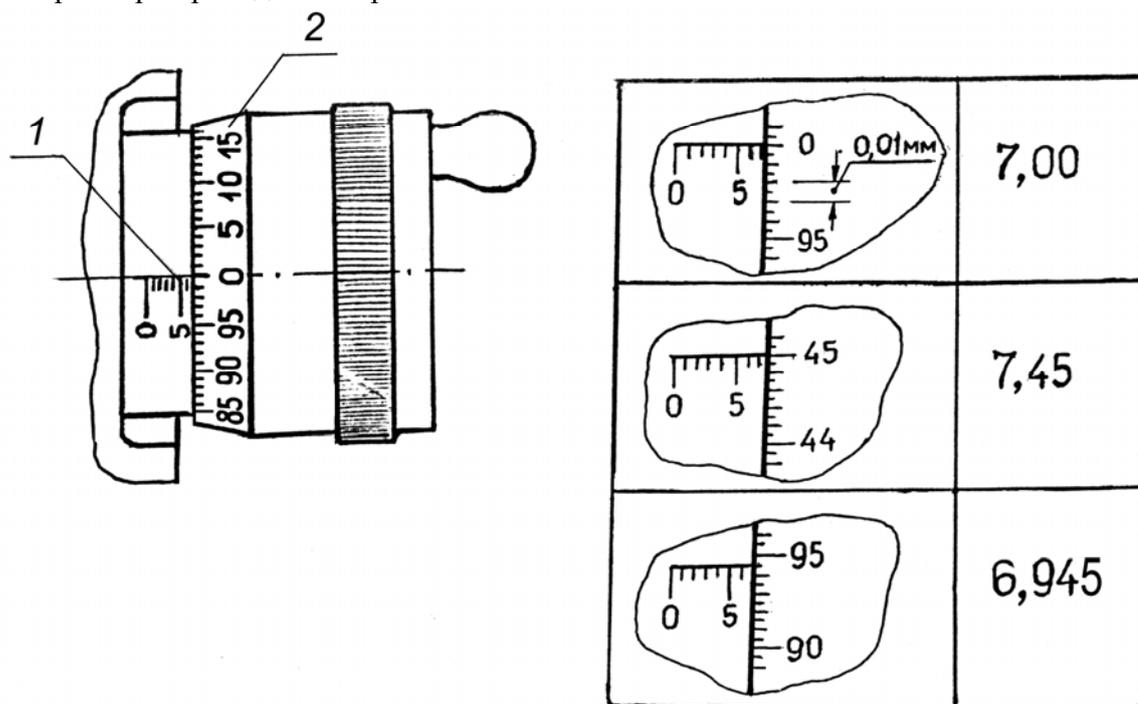
Рис.5. Шкалы микрометров и примеры отсчётов по ним.
