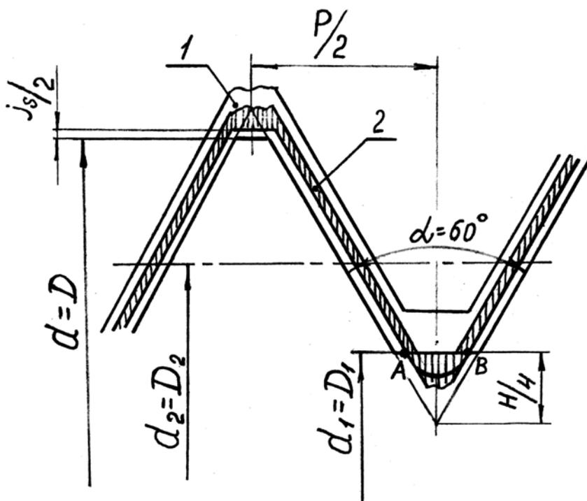
Рис.20. Схемы полей допусков нарезаемой резьбы и резьбы метчика:
