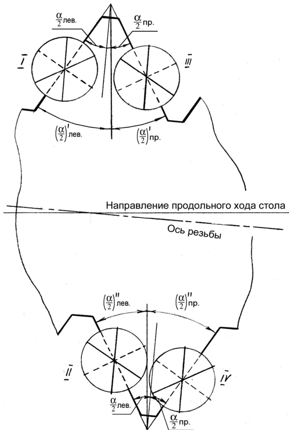
Рис.19. Схемы измерения левой (положения I и II) и правой (положения III и IV) половин угла профиля резьбы.
