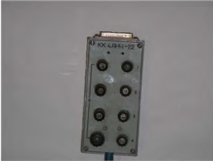
Рис. 3.2. Внешний вид клеммной колодки аппаратуры 4АНЧ-22
