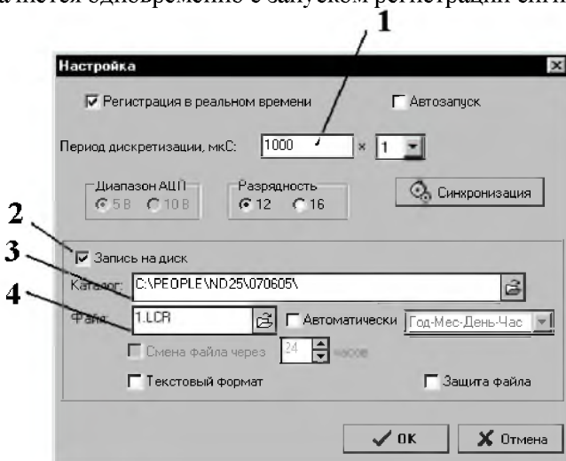
Рис. 4.4. Окно «Настройка» программного комплекса Gemis Oscilloscope: 1 – поле установки периода дискретизации; 2 – поле установки записи сигнала на диск; 3 – поле установки каталога для записи; 4 – поле установки имени файла
