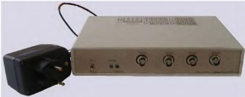
Рис. 3.3. Внешний вид усилителя заряда РШ-2734
