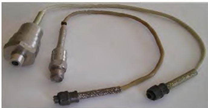
Рис. 2.2. Внешний вид тензометрических датчиков пульсаций давления ЛХ-412 и ЛХ-415
