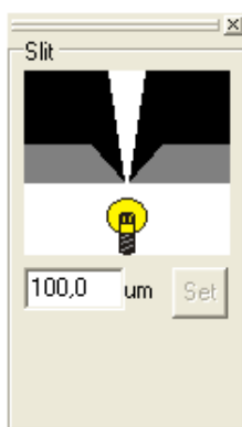
Рис. 17 – Панель настройки ширины входной щели
