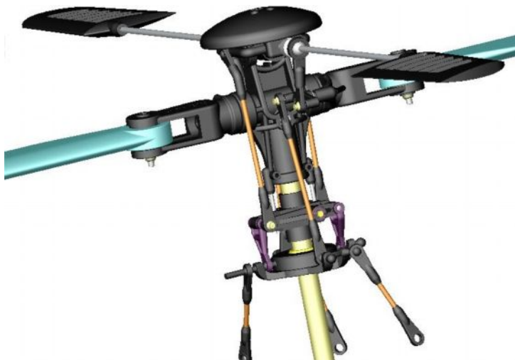
Рис. 2 – Механизм стабилизации вертолета
