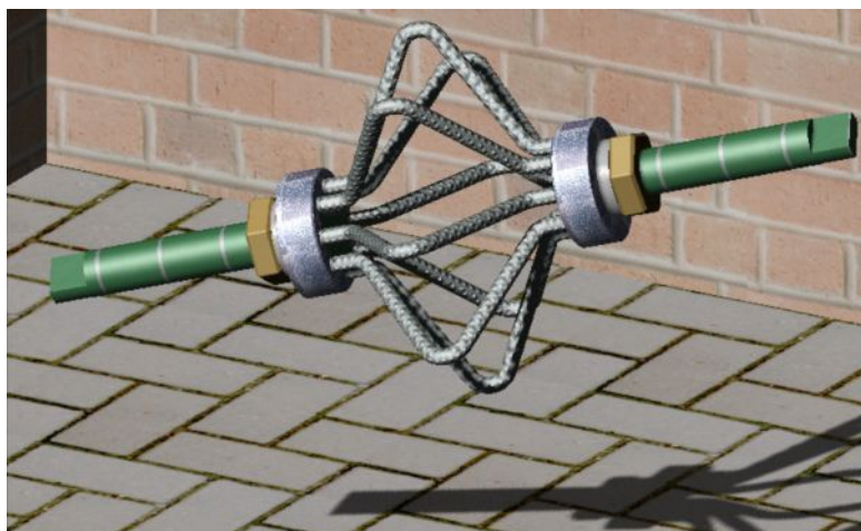
Рис. 5 – Фотореалистичная модель тросового виброизолятора
