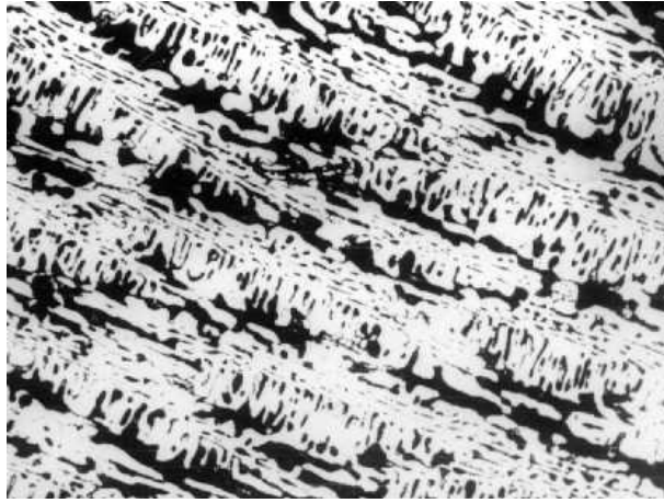
Рис. 8. Микроструктура эвтектического чугуна с содержанием углерода 4,3%
