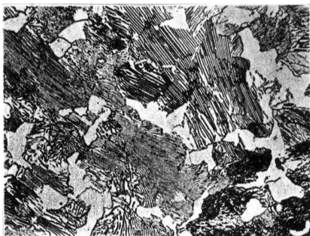
Рис. 4. Микроструктура доэвтектоидной стали с содержанием углерода 0,6%
