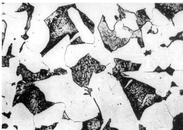
Рис. 3. Микроструктура доэвтектоидной с содержанием углерода 0,45% (стали 45)
