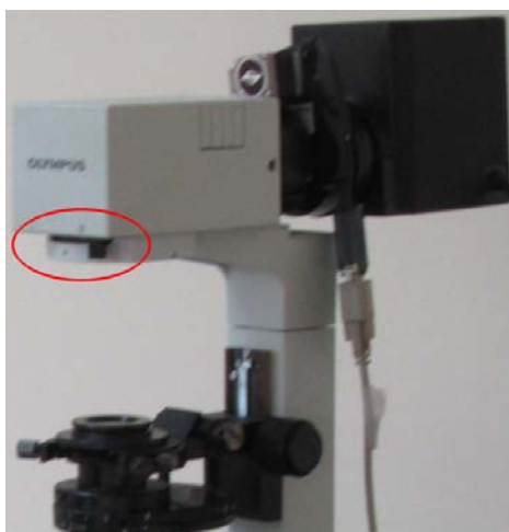
Рис. 17 Ирисовая диафрагма галогеновой лампы
