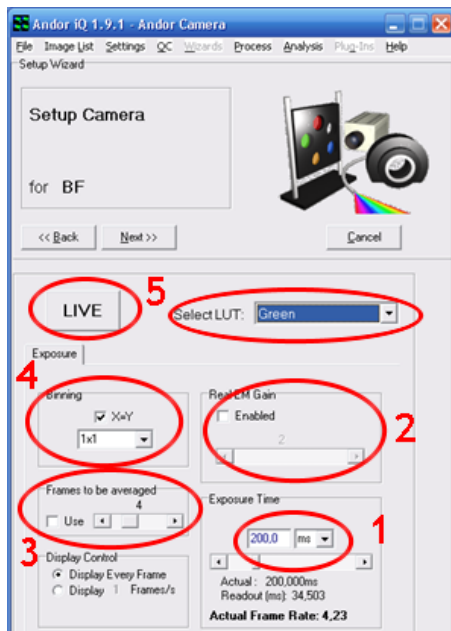
Рис. 26 – Задание настроек камеры и вывода изображения: 1 – выбор времени экспозиции, 2 – управление электронным усилением, 3 – управление покадровым усреднением, 4 – сложение пикселей, 5 – запуск отображение изображения, 6 – режим отображения изображения
