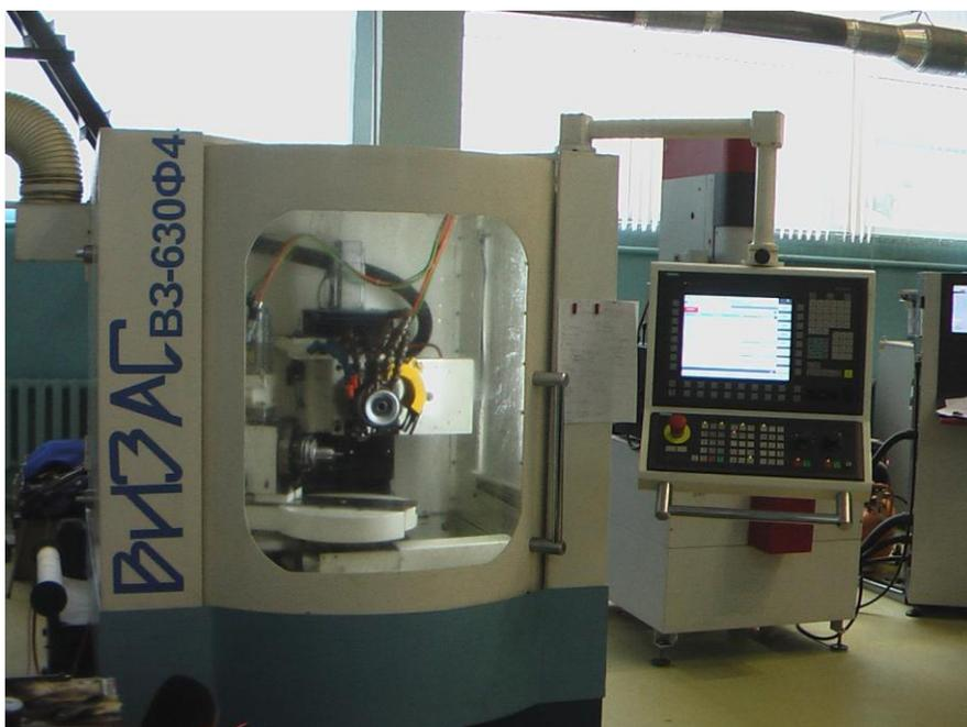
*Рис. 1.* Шлифовально-заточной центр с ЧПУ ВЗ-630Ф4
