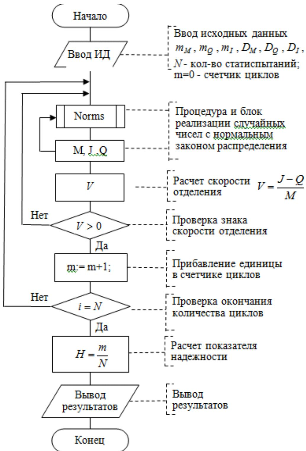
Рисунок 6.6 - Блок-схема алгоритма реализации метода статистических испытаний с помощью непосредственного вычисления показателя надежности
