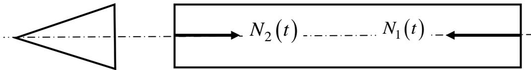
Рисунок 6.1 - Расчетная схема отделения головной части от ракетного бока
