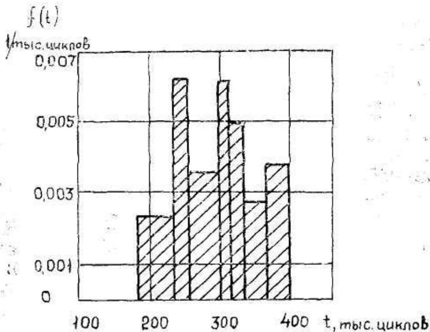
Рисунок 1.4 - График плотности вероятности отказа пружин
