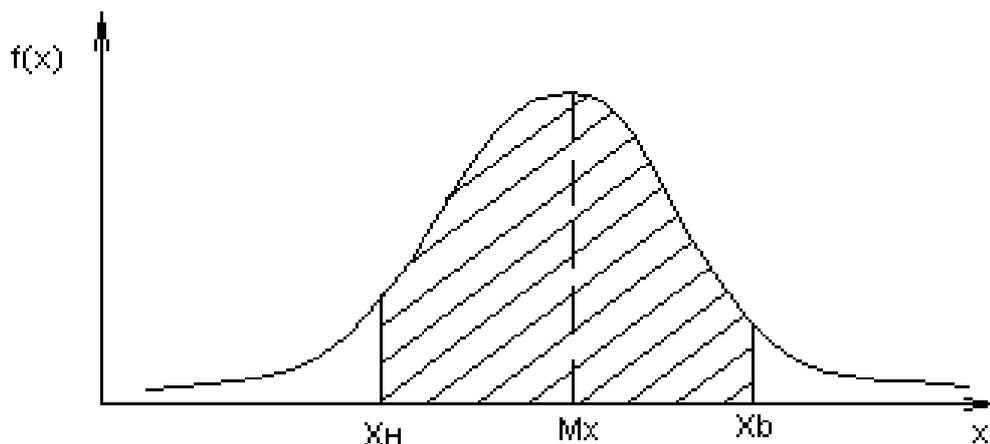
Рисунок 3.1 - К понятию доверительного интервала
