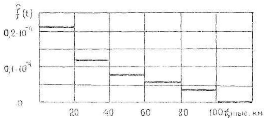
Рисунок 1.6 - График плотности распределения наработки до отказа
