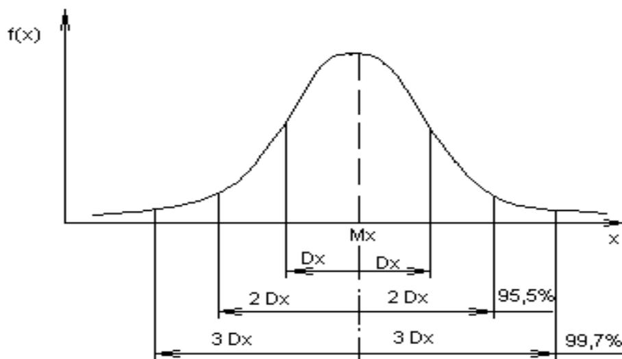
Рисунок 3.2 - Доверительные интервалы для нормального закона распределения
