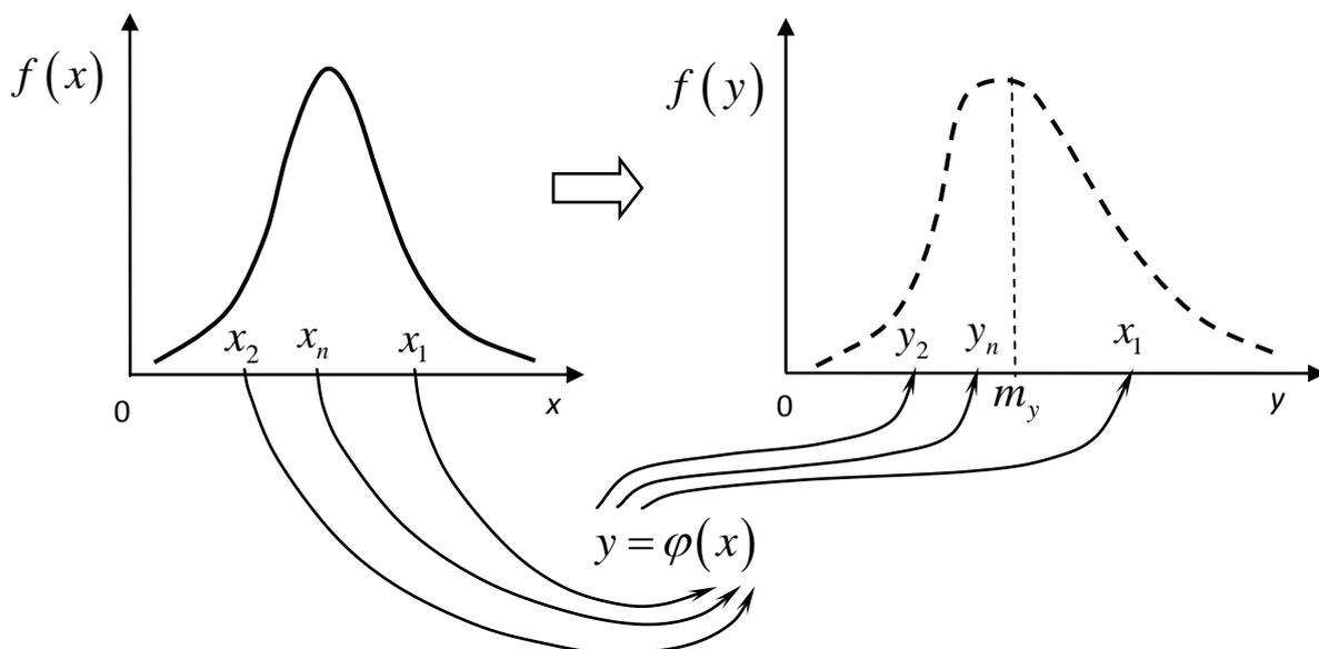
Рисунок 6.3 - Иллюстрация метода статистических испытаний
