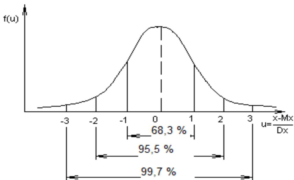
Рисунок 3.3 - Доверительные интервалы для нормированного нормального закона распределения
