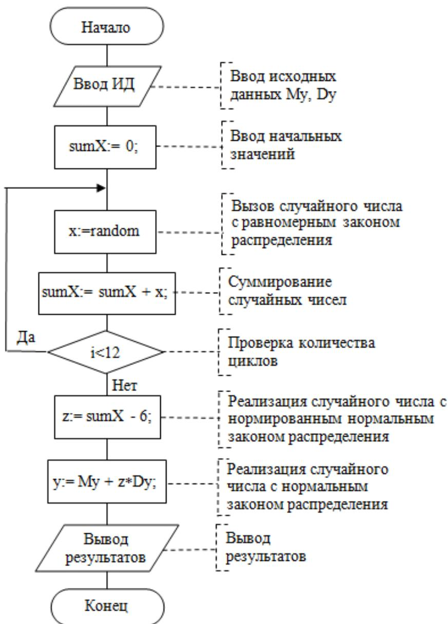
Рисунок 6.5 - Блок-схема реализации нормального закона распределения на ЭВМ
