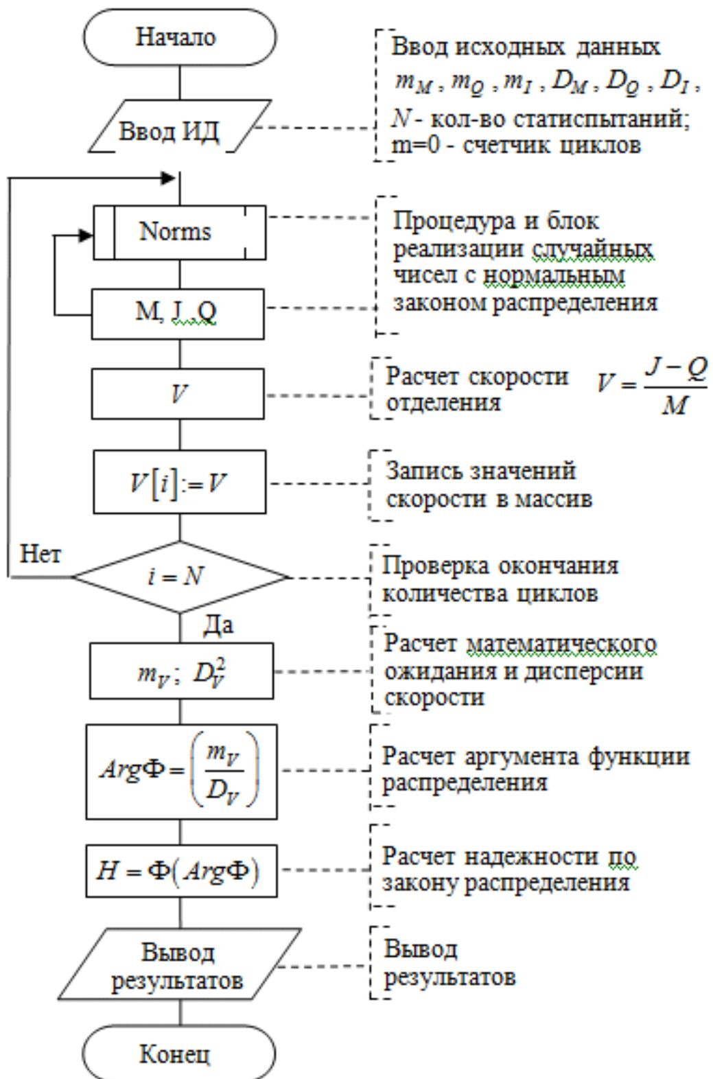
Рисунок 6.7 - Блок-схема алгоритма реализации метода статистических испытаний на основе решения задачи статистической динамики
