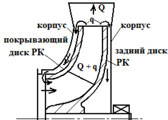
Рисунок 2 - Схема утечек в центробежном насосе
